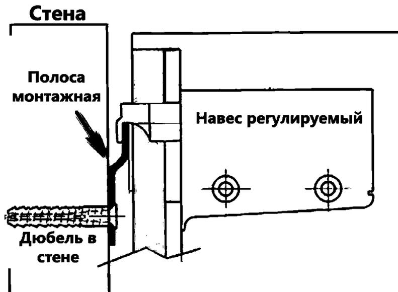
3) Используя дюбели и винты (поставляются в комплекте) закрепите металлические монтажные полосы для навесов на стене, располагая их таким образом чтобы они оказались в пределах внутреннего габарита откидного компьютерного стола FlatDesk™.
